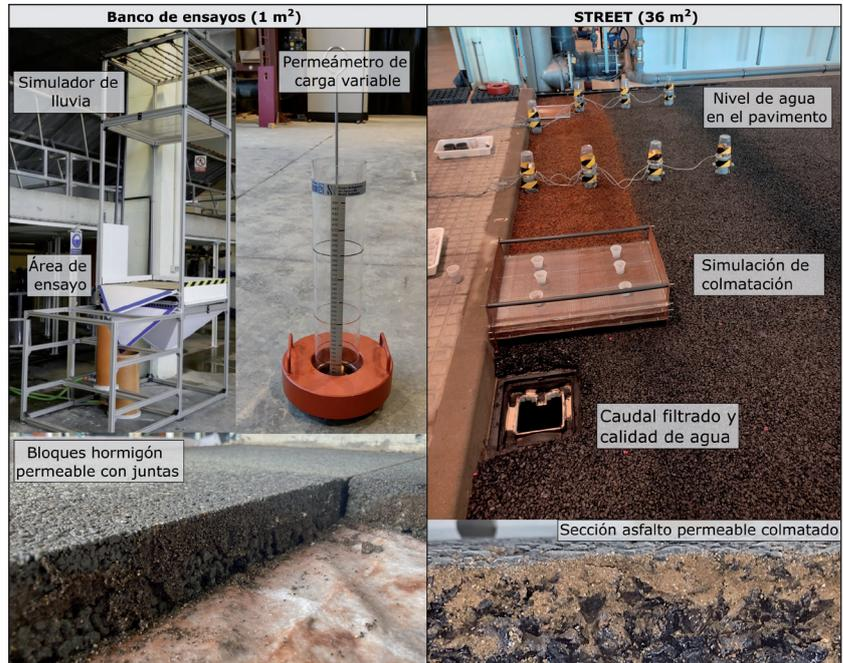
A pesar de los numerosos trabajos realizados a nivel internacional, en la actualidad no existe un método o procedimiento estandarizado aceptado para la caracterización hidráulica de pavimentos permeables que considere además la pérdida de capacidad de infiltración producida por la colmatación. Por este motivo, Co-UDlabs pretende proponer una metodología para el análisis de estos pavimentos basada en el amplio conocimiento adquirido.
