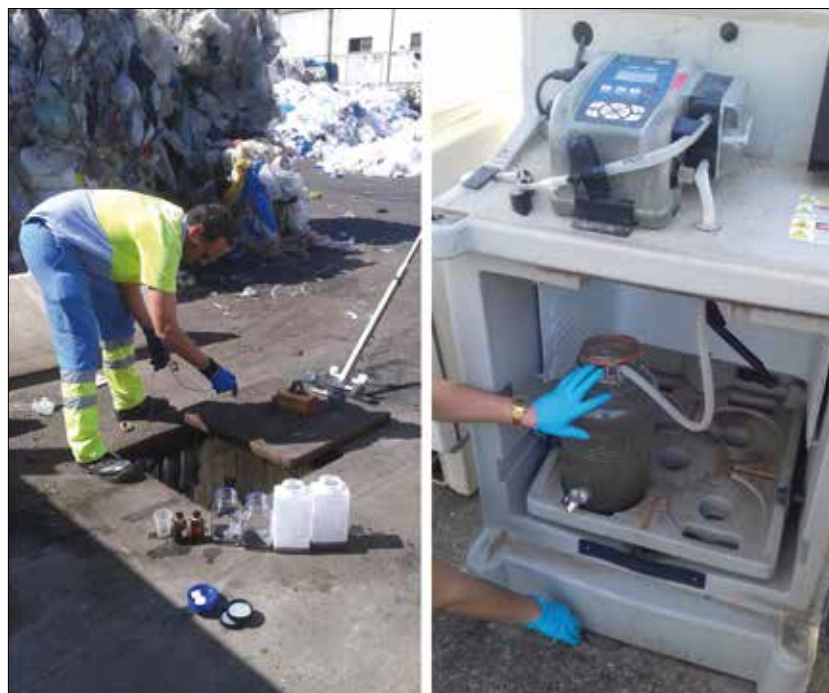
FIGURA 2. Muestreos con tomamuestras instalado en EDAR y muestreo simple en industria de reciclado.
