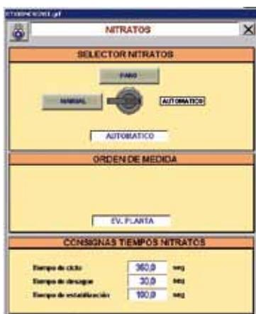
**Figura 3.** Pantalla de consignas de proceso y alarmas del sistema.
