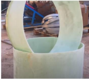
RECÓGIDA MUESTRAS EN LA PROPIA OBRA, DE LA MANGA CURADA, PARA SU TRASLADO A LABORATORIO
